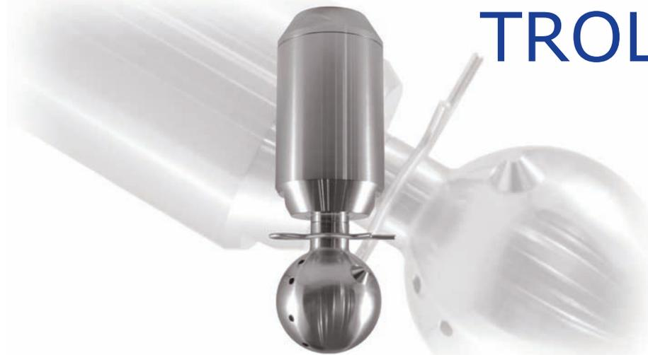
Das einfache und effektive Antriebssystem des TROLL BALL 2" erzeugt eine langsame und konstante Rotation. Dieser Vorgang liefert eine durchgehende Reinigung mit unterschiedlichen Reinigungsmedien und einem großen Temperaturbereich. Der TROLL BALL besteht nur aus wenig beweglichen Teilen und bietet somit eine kompakte und zuverlässige Reinigungslösung mit geringem Wartungsaufwand. Der TROLL BALL ist ideal als Ersatz von fixen oder rotierenden Sprühkugeln.
